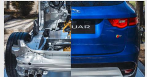
Das Chassis des Jaguar F Pace besteht zum Großteil aus Aluminium. Bild: JLR
