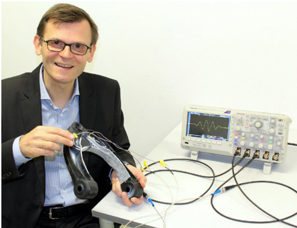
Leichtbauteil mit applizierten Sensoren zur Strukturzustandsüberwachung, Bild: Christoph Kralovec
